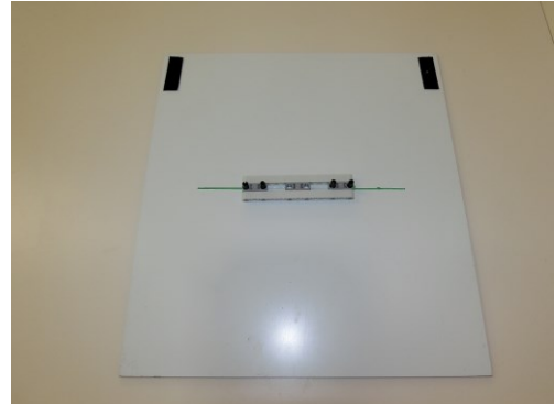
Plattenbefestigung auf Kunststoffplatte aufgeklebt
